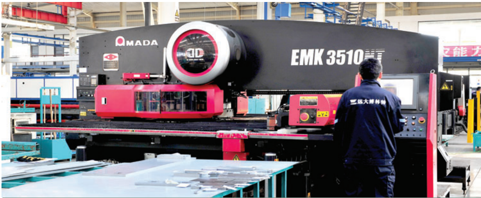
Линия по обработке стального листа AMADA EMK3510, Япония
